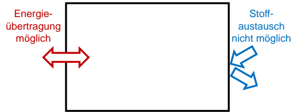
Abbildung 1.3: Geschlossenes System mit der Möglichkeit der Energieübertragung aber ohne Möglichkeit des Stoffaustausches (Beispiel: Handwärmer)
