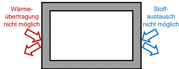
Abbildung 1.4: Isoliertes (abgeschlossenes) System ohne Möglichkeit der Energieübertragung und des Stoffaustausches (Beispiel: idealisierte Thermoskanne)
