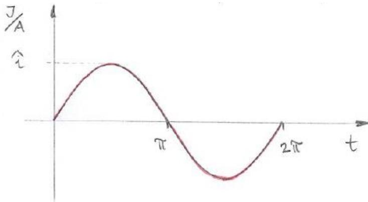
Die Sinushalbwellen des Wechselstromes mit  $i = \hat{i} \sin \omega t$  und  $\hat{i} = 10 \text{ A}$  (siehe folgendes Bild) werden nun angeschnitten. In den Bereichen  $0 < \omega t < \alpha$  und  $\pi < \omega t < (\pi + \alpha)$  fließt kein Strom ( $i = 0$ ), wobei  $\alpha = \pi/4 = 45^\circ$  sei.
