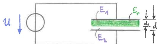
In beiden vorhandenen Schichten (Isolierstoffplatte und Luftsicht) herrscht die gleiche elektr. Flussdichte  $D$ .
