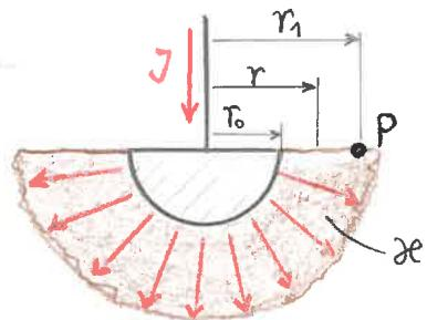
Durch den fließenden Strom  $J$  besteht im Erdreich ein Strömungsfeld mit radial nach außen laufenden Strömungslinien. Im Abstand  $r$  vom Mittelpunkt des Erders verteilt sich der Strom  $J$  auf den Mantel einer Halbkugel mit dem Radius  $r$ , also auf die Fläche  $A = 2\pi \cdot r^2$ .
