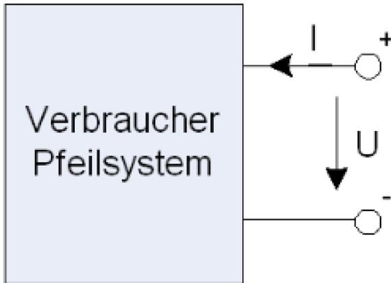
Richtung von Strom/Spannung an einem Tor := „Zählpfeilsystem“ → LERNEN!
