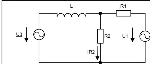
$U_0=10V/0^\circ$ ;  $U_1=20V/30^\circ$  beide mit  $f=10kHz$
