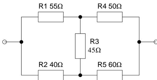
**B25. Gegeben sei  $I_1 = 1,25 \text{ A}$ ,  $I_2 = 350 \text{ mA}$ ,  $I_3 = -125 \text{ mA}$ ,  $I_5 = -0,3 \text{ A}$ . Gesucht:  $I_4$  (Lsg: 475mA)**
